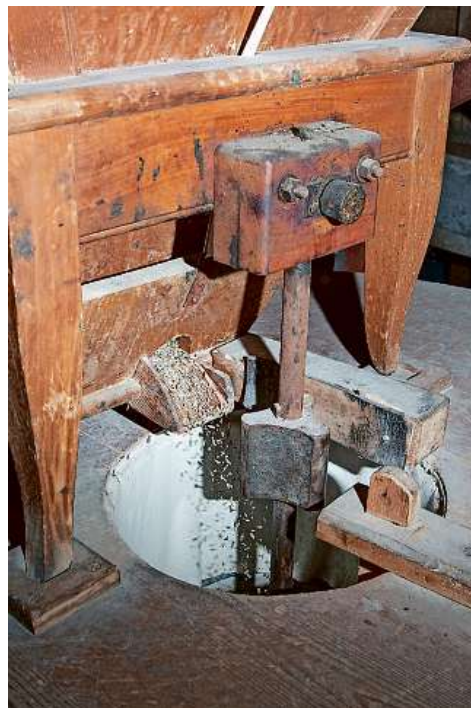
Vom Einfülltrichter aus fallen die Körner zwischen die beiden Mühlsteine.
