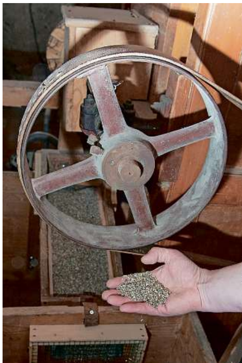
Bis zu zehnmahl werden die gequetschten Körner gemahlen, bis der richtige Mahlgrad erreicht ist.
