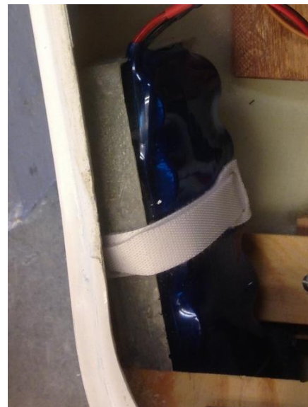
Akkuhalter an der linken Rumpfwand
