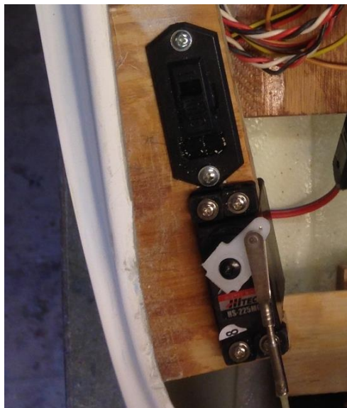
Klinke und Klinkenservo an der rechten Rumpfwand
